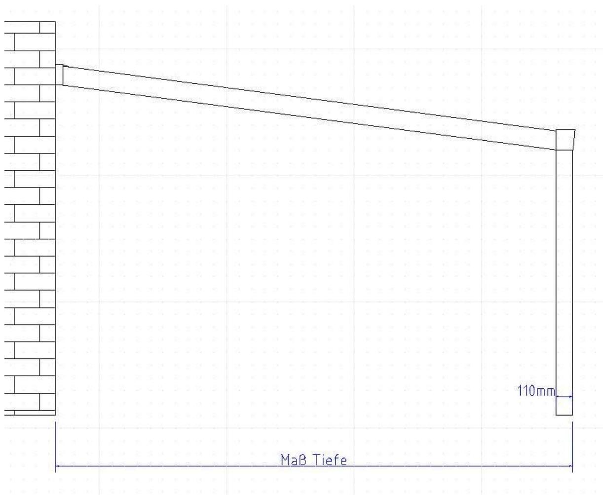
**Maß Tiefe:** Dies ist das Maß von Hauswand zur Außenkante Stütze.
