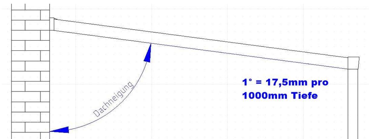
**Dachneigung:** Dies bezeichnet das Gefälle zwischen der hinteren und vorderen Höhe.
