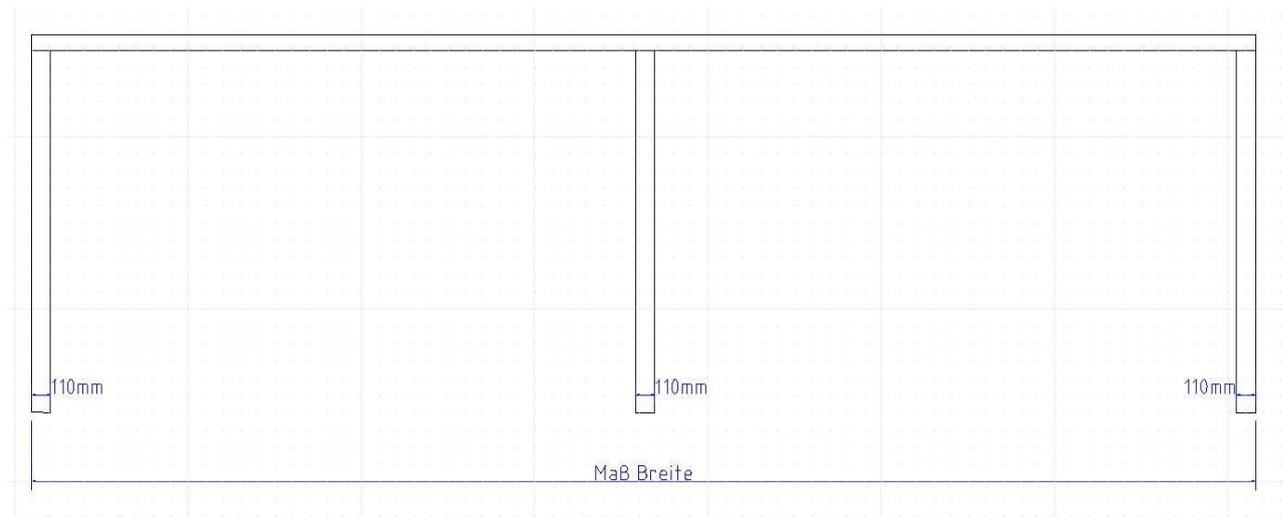
**Maß Breite:** Dies ist das Maß von Außenkante linke Stütze zur Außenkante rechte Stütze.
